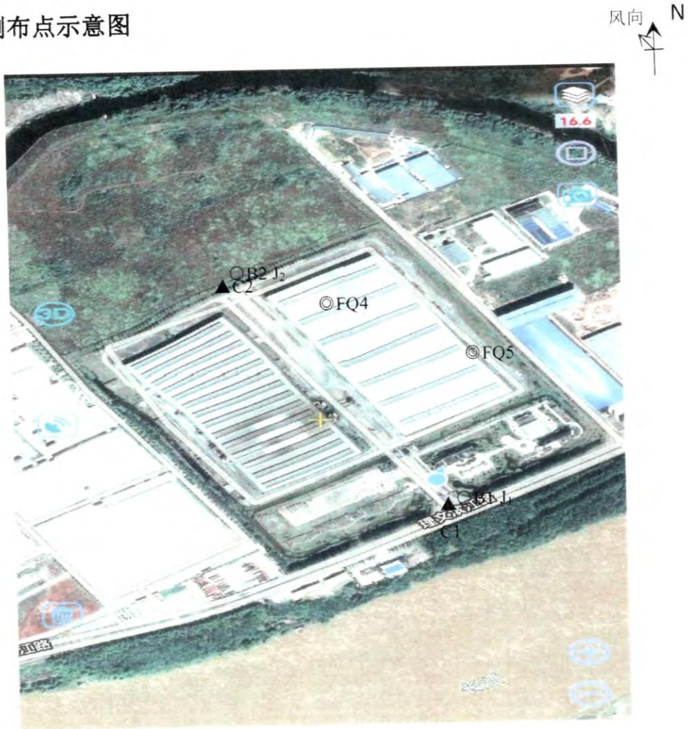
图例：◎——有组织废气检测点，○——无组织废气检测点，▲——噪声检测点。
